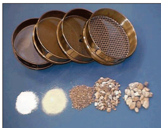
Obrázek 2 Třídění částic písku a štěrku podle jejich velikosti na sítích (zdroj: http://www.fhwa.dot.gov/engineering/geotech/pubs/05037/05a.cfm )
