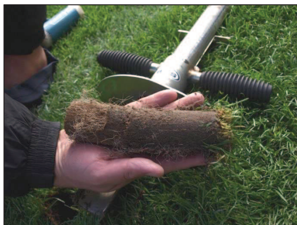
Obrázek 10 Fibre sand použitý ve vegetační vrstvě na fotbalovém hřišti v Glasgow (foto Hejduk)
