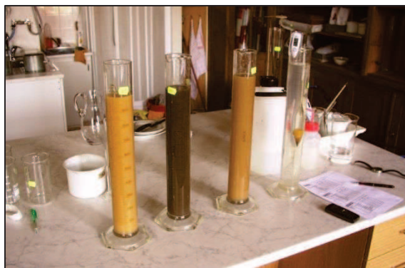
Obrázek 6 Měření podílu jemných částic v zemině hustoměrnou metodou (foto Hejduk)
