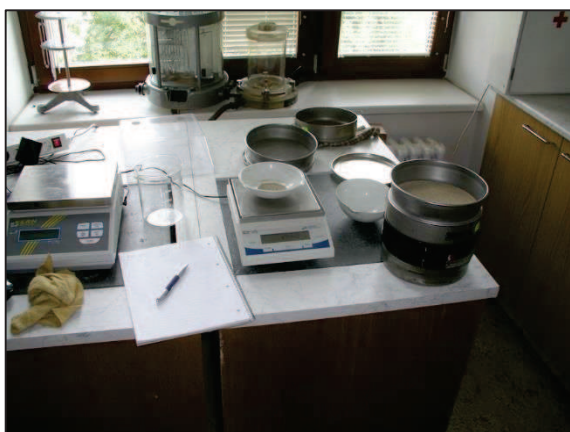
Obrázek 1 Vážení podílu jednotlivých frakcí písku síťovou metodou po proplavení vodou a následném vysušení (foto Hejduk)
